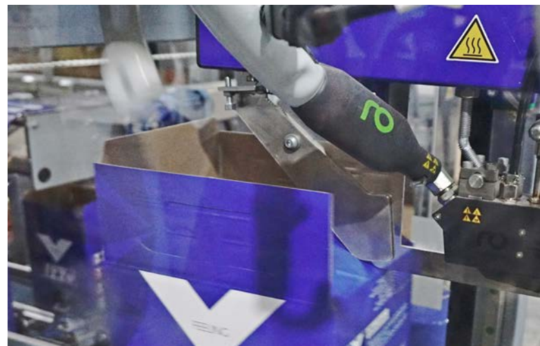
Manguera calefactora Performa y cabezal de aplicación AX Diamond
