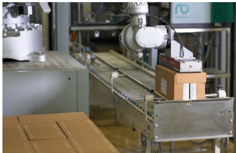
Stabling av sekundæremballasje på paller med limstrimler
