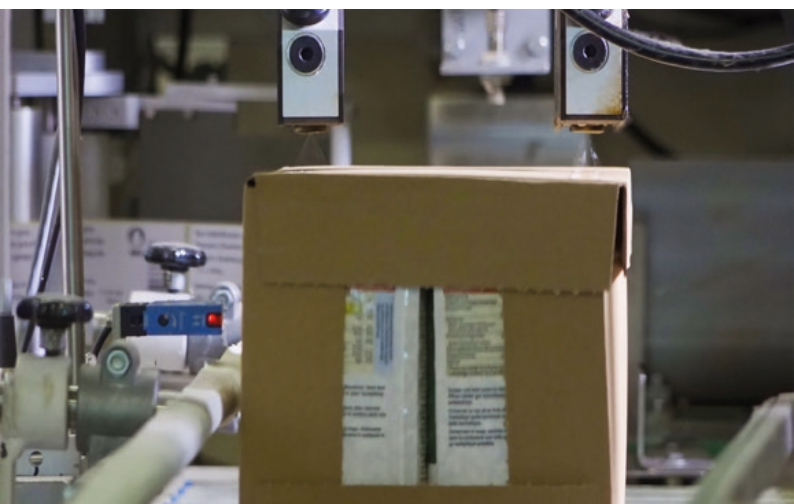
Två spruthuvuden av typen AX Diamond vid limappliceringen
