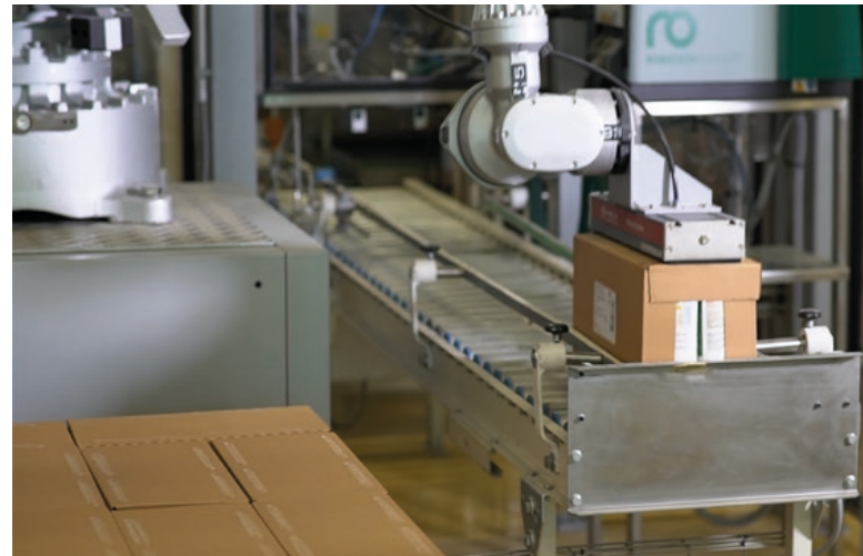
İkincil ambalajların tutkal uygulaması ile paletlenmesi
