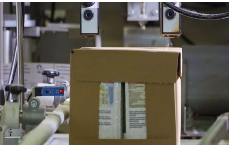
Twee AX Diamond-applicatiekoppen die de lijm aanbrengen
