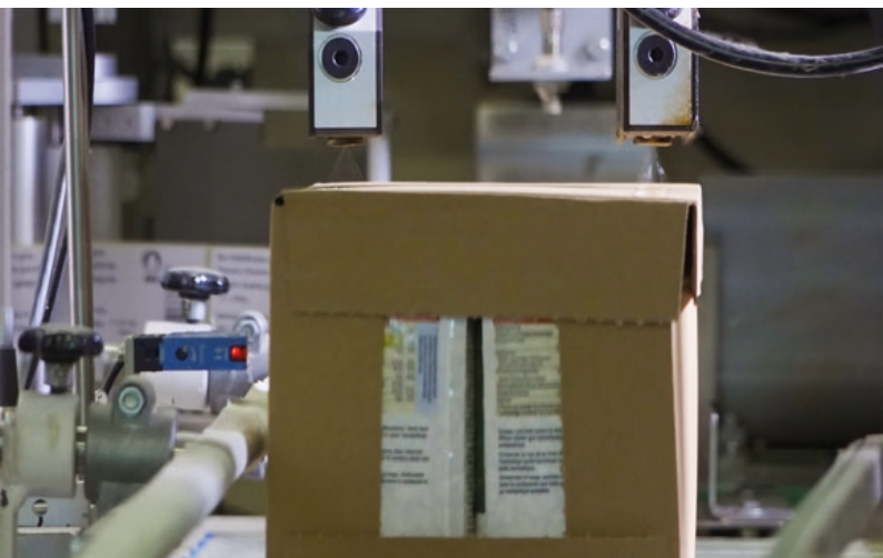
Dwie głowice napyłające klej AX podczas nanoszenia kleju
