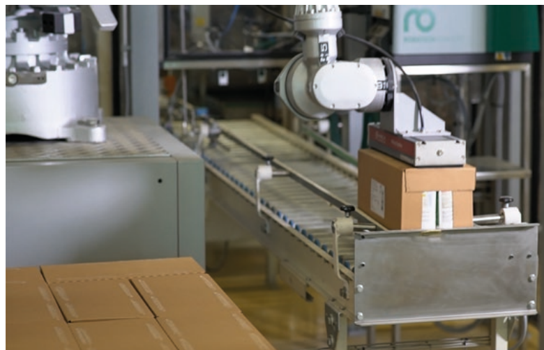
Paletowanie opakowań wtórnych z paskami samoprzylepnymi
