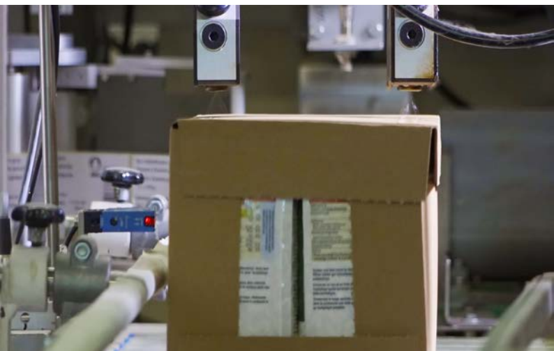
两个 AX Diamond 型喷枪在喷涂胶粘剂
