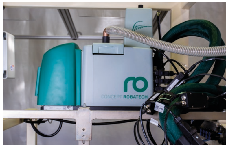
搭载 RobaFeed 自动加料装置的 Concept Stream 熔胶系统
