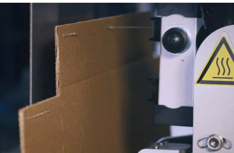
Application intermittente de cordons de colle sur les rabats de couvercle avec le modèle SX LongLife
