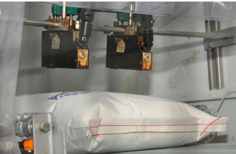
2 adet AX Diamond aplikasyon kafası ile spiral şekilde temassız uygulama
