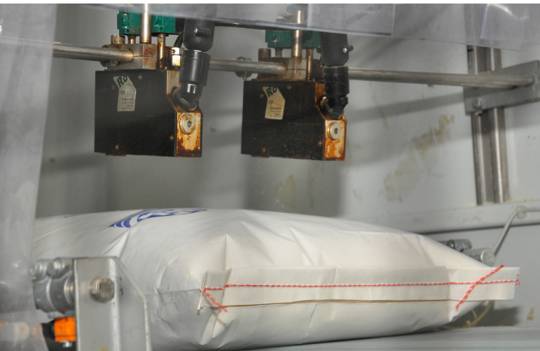
Dos cabezales de pulverización AX Diamond aplican un espolado de Hotmelt sin contacto
