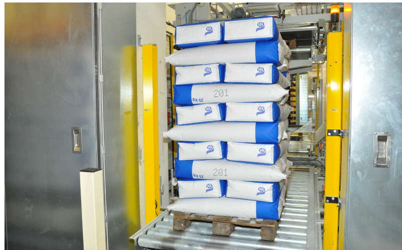
完成码垛的堆垛离开码垛设备
