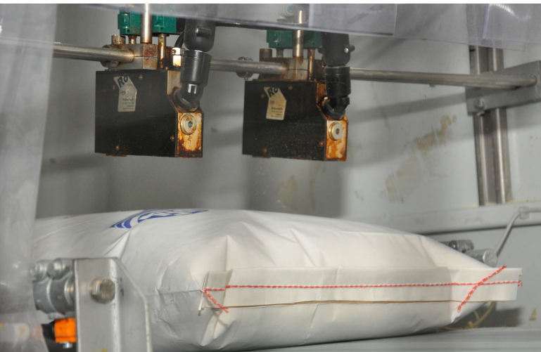
两个 AX Diamond 喷枪无接触式喷涂热熔胶环
