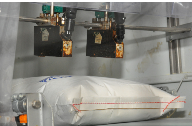
两个 AX Diamond 喷枪无接触式喷涂热熔胶环
