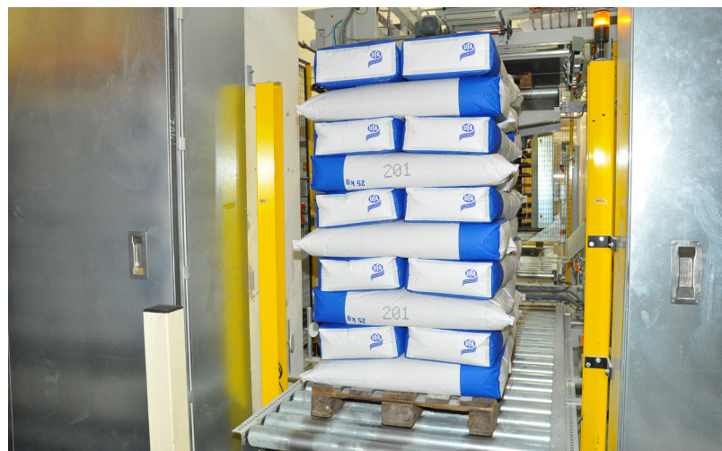
完成码垛的堆垛离开码垛设备
