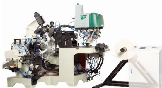
*La máquina de conos de papel de Dayuan con equipo fusor Concept de Robatech (parte superior) y el cabezal de aplicación AX*
