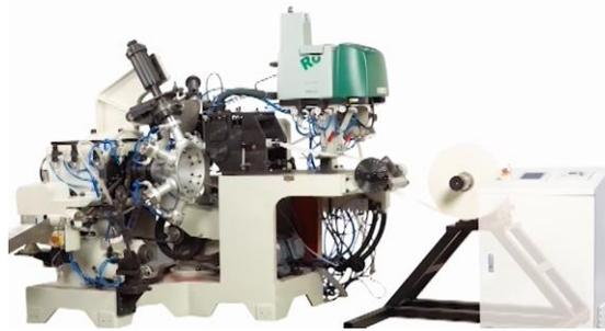
*Dayuan Papierbecher-Maschine mit Robatech Concept-Schmelzgerät (oben) und AX Diamond-Auftragskopf*
