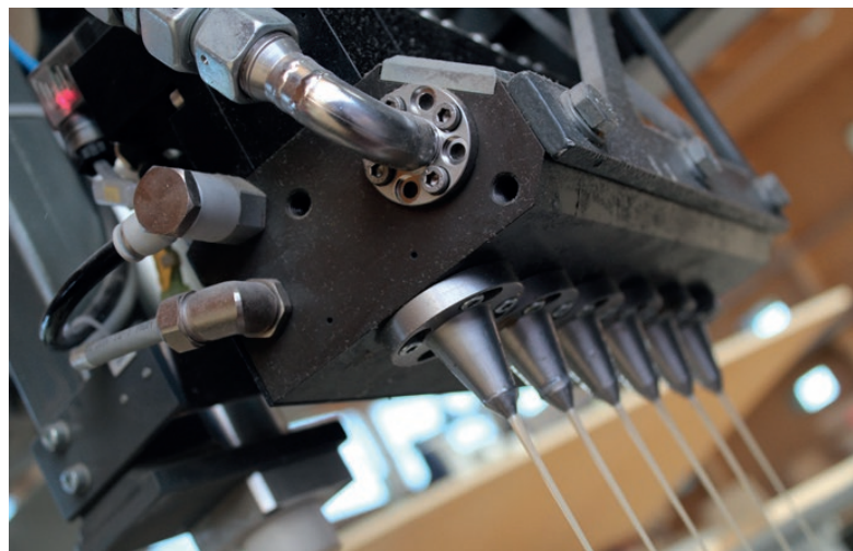
用于 1K-PUR 胶粘剂涂覆的多喷嘴详细试图。
