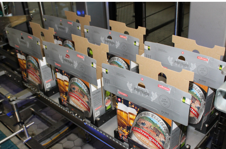
İlk tutkallama işleminden sonra karton kutular
