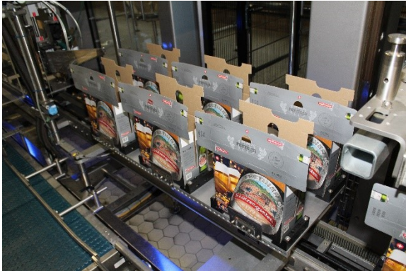
Confezioni erette dopo il primo incollaggio
