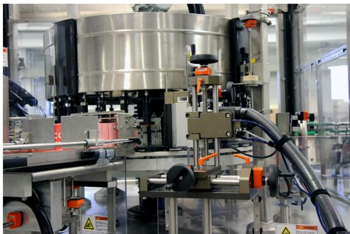
ci applique avec précision une fine pulvérisation de colle en spirale directement sur la boîte. Avec le point de colle en spirale appliqué, la boîte continue de tourner autour de son propre axe sur le distributeur rotatif de sorte à être correctement orientée pour récupérer une étiquette dans un magasin d'étiquettes prédécoupées lorsqu'elle passe au niveau de celui-ci. En continuant de tourner sur le distributeur rotatif, la boîte
