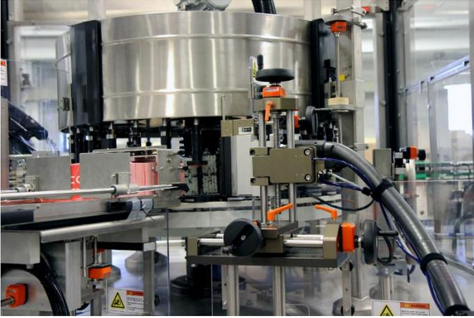
动将标签完全拉出料盒之前不久，第二个热熔胶喷枪将一条胶粘剂喷涂到标签的后边缘内侧。该第二个喷枪还用于将标签的尾部重叠粘贴到标签前边缘上，使标签重叠封闭成环。
