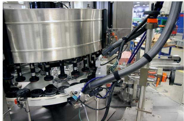
克朗斯的 **Canmatic** 专为具有成本效益的预切标签贴标设计。除了经典钢罐这种流行的应用，该机器还擅长将预切的纸或薄膜环绕式标签粘贴到尺寸和形状各异的罐、瓶或广口瓶上。该机器的工作原理简单而有效——标签直接粘贴到容器上，无需粘合托盘。**Canmatic** 仅通过两条很细的热熔胶线将标签粘贴到位，仅需最少量的胶水即可完成粘贴任务。
