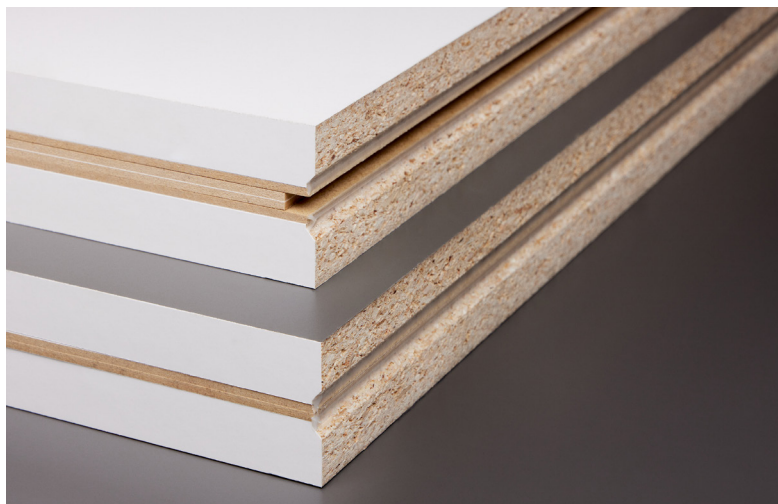
Fertiges „Buch“: Die Schrank-Seitenwände sind mit der Rückwand verklebt
