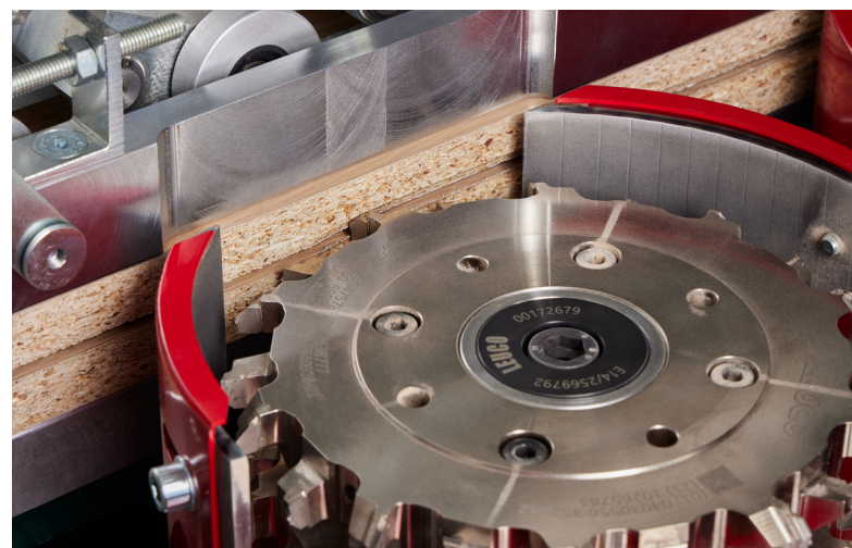
Zweiter Arbeitsschritt: Eine präzise Fuge wird in die Seitenwände gefräst
