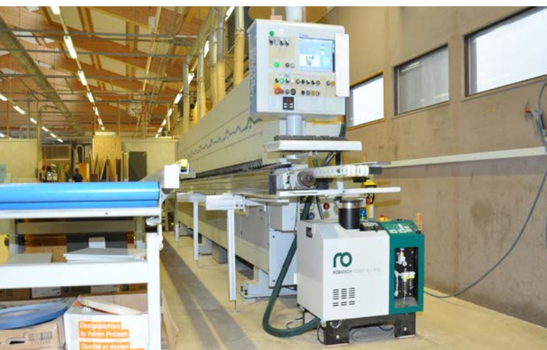
La plaqueuse de chants : comment créer des chants sans joint visible
