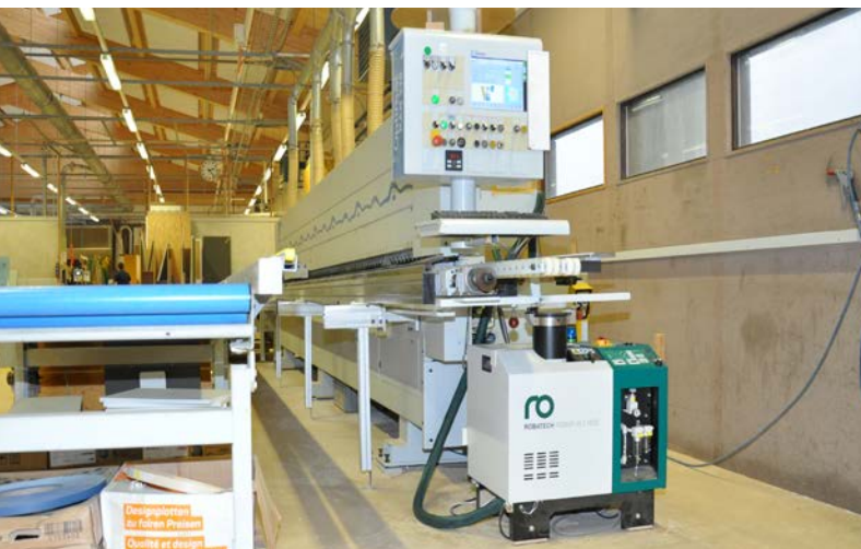
La bordatrice: qui si realizzano le bordature effetto ottico Zero Joint
